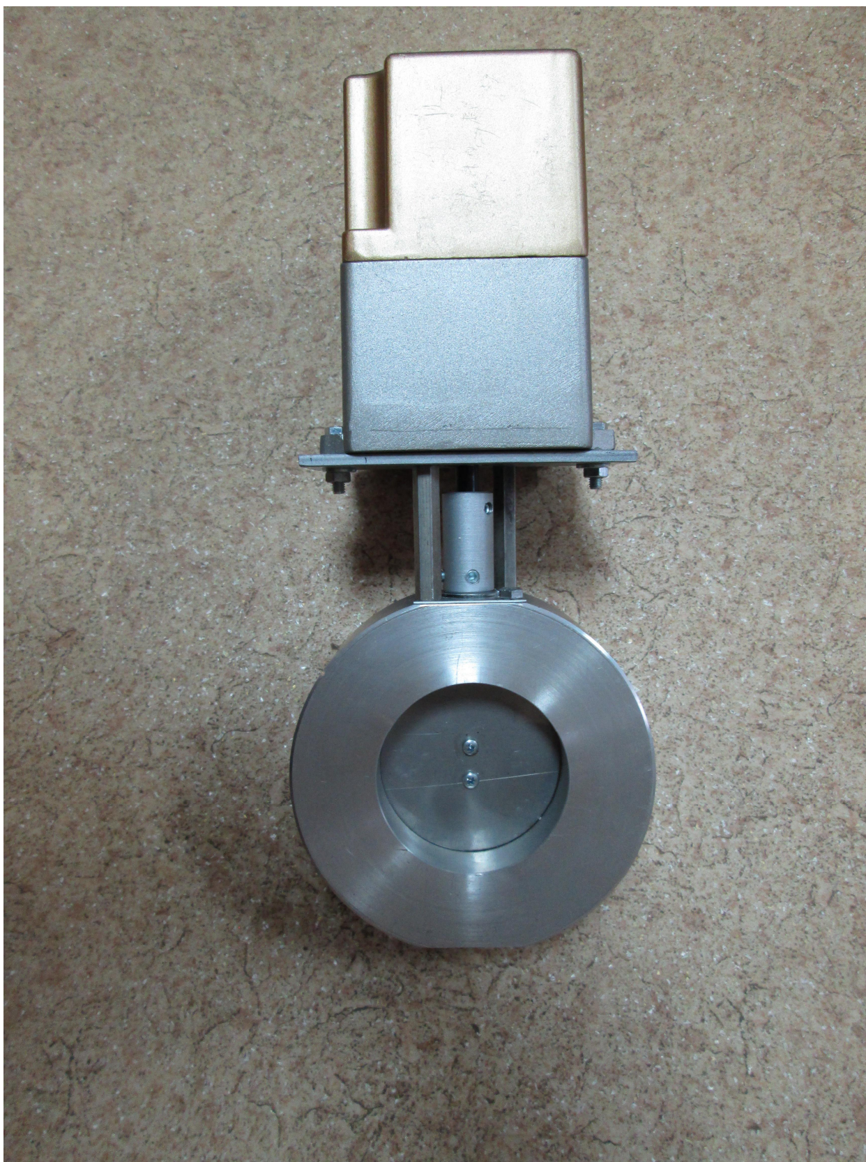
Фото 1. Внешний вид заслонки ЗГП на рабочее давление (0-100) кПа.
